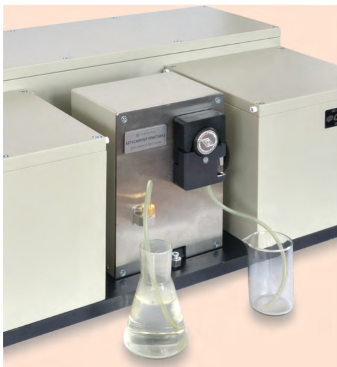
Фурье-спектрометр ФСМ 2201, приставка-автосамплер для анализа бензинов
