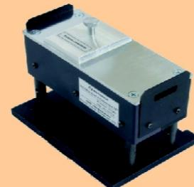
Назначение: измерение очень тонких покрытий, имеющих толщину в нанометровом диапазоне, и исследование мономолекулярных слоёв.
